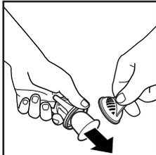
2. Insérer le filtre dans la base. Enclencher le couvercle sur la base.
