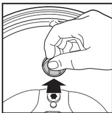
2. Le filtre se bloque en position sur le joint du réservoir à café
