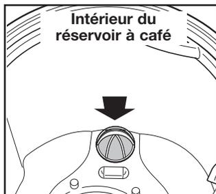
1. Soulever le filtre pour l'enlever du réservoir à café. Rincer le filtre sous un jet d'eau pour le nettoyer complètement.
