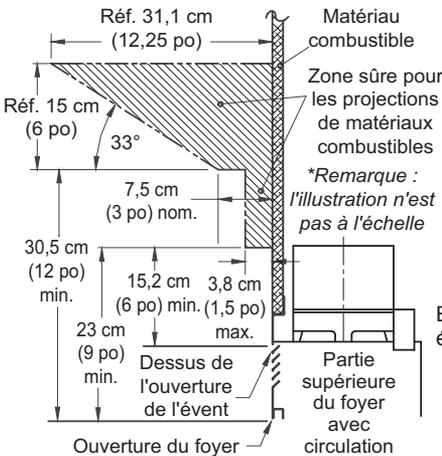
Figure 4 - Dégradations du manteau de foyer par rapport aux matériaux combustibles
