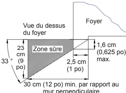
Figure 5 - Dégradement du manteau de foyer latéral
