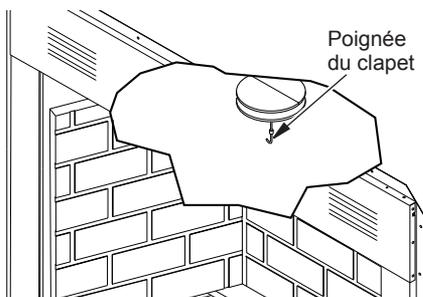
Figure 24 - Emplacement de la poignée du clapet
