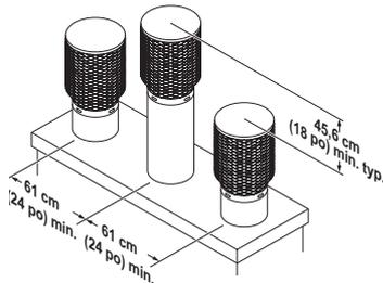
Figure 18 - Installation avec plusieurs enchâssures
