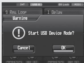
**3 Seleccione OK/Cancel utilizando el control EFX SELECT (EFX2), y pulse el control para introducir la selección.**
