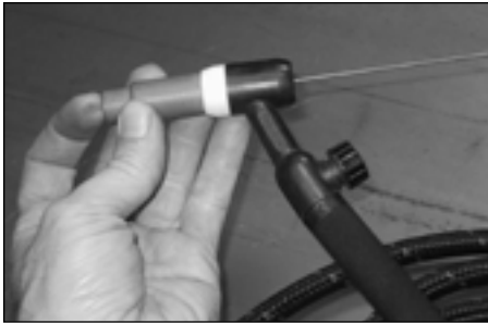
Figure 4 - Tungstène doit sortir de 3/16 po
