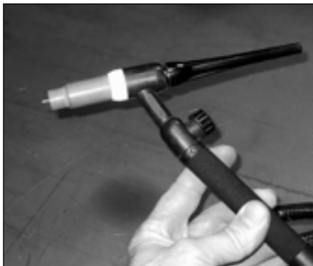
Figure 5- Installaton de coupelle de retour
