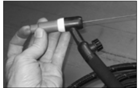
Figura 4 - El tungsteno debe sobresalir 0,5 cm (3/16'')
