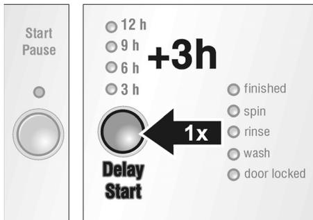
El tiempo de remojo puede extenderse hasta un máximo de 12 horas, en pasos de 3 horas, presionando las veces necesarias el botón **Delay Start**. El tiempo de arranque **Start** comienza a contar inmediatamente después del ajuste.
