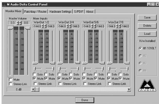
La fenêtre «Monitor Mixer» regroupe des faders de volume, des afficheurs de niveau audio (ou crêtes-mètres) ainsi que des commandes de Solo et de Mute. Chacun des canaux d'entrée et de sortie du mélangeur dispose d'une commande de volume, d'un crête-mètre, d'une commande de solo et d'une commande de mute.
