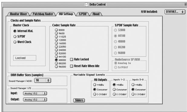
**VARIABLE OUTPUT LEVELS (niveaux de sortie variables)** : cette section est partagée en deux, ce qui permet un contrôle extrêmement complet des niveaux d'entrée et de sortie de votre Delta 1010LT.
