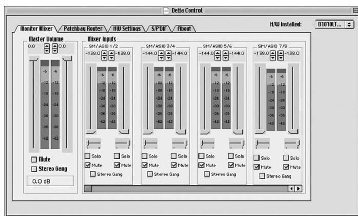
La fenêtre «Monitor Mixer» regroupe des faders de volume, des afficheurs de niveau audio (ou crêtes-mètres) ainsi que des commandes de Solo et de Mute. Chacun des canaux d'entrée et de sortie du mélangeur dispose d'une commande de volume, d'un crête-mètre, d'une commande de solo et d'une commande de mute.
