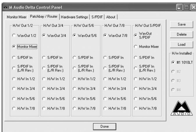
Panel». Dans la première colonne de la fenêtre «Patchbay/Router», cliquez sur le bouton «Monitor Mixer» afin de relier la sortie stéréo du mélangeur interne («Monitor Mixer») directement aux sorties analogiques «OUT1» et «OUT2» de la Delta 1010LT. A présent, les signaux transmis par les sorties 1 et 2 reflètent les réglages effectués dans la fenêtre «Monitor Mixer».
