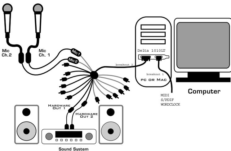
Supposons qu'après avoir enregistré deux pistes de voix, nous souhaitons y ajouter d'autres pistes de voix en même temps que nous écoutons les deux premières. Dans le schéma qui suit, deux micros dynamiques sont connectés aux entrées 1 et 2 de la Delta 1010LT. D'autres instruments, des claviers ou des modules MIDI par exemple, pourraient également être connectés directement aux entrées de la carte.
