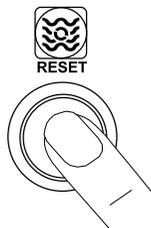
**REMARQUE :** Si le brûleur ne s'allume pas dans les 15 minutes, le système passe en mode de verrouillage de sécurité, désactivant le bouton « RESET » (remise à zéro). Dans ce cas, mettez les commandes « HEAT » (chaleur), « BLOWER » (soufflerie) et « CONVEYOR » (transporteur) en position « OFF » (O). Attendez AU MOINS CINQ (5) MINUTES. Répétez ensuite la procédure de mise en service quotidienne.
