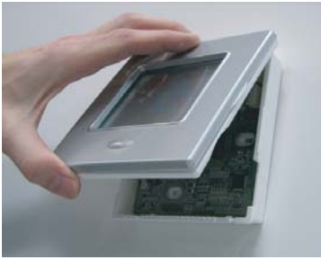
Fig. 15 - Reattach Display Module
